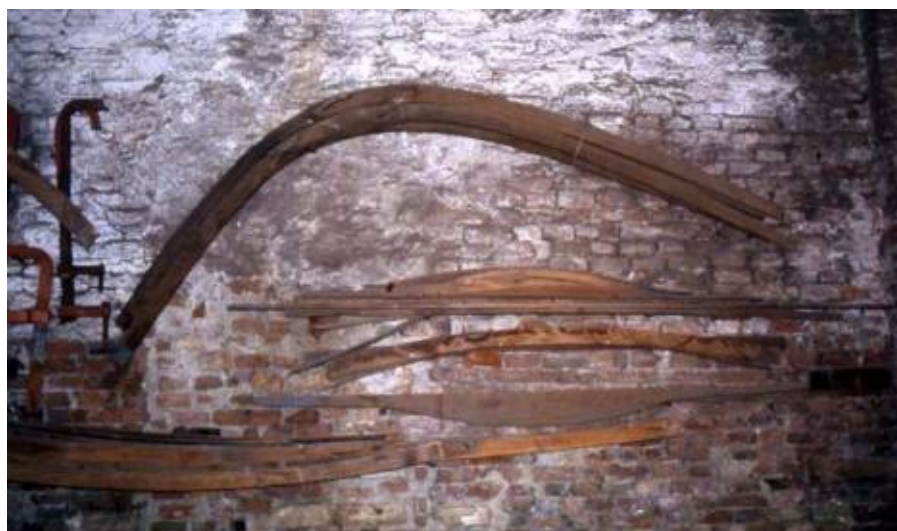
Fig. 7. Sagome e forme per modellare le estremità di poppa e prua di una peata , una barca veneziana da carico di 16 metri di lunghezza e 37 tonnellate di portata. Cantiere Antonio Amadi, Burano, Venezia.
