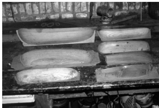
Fig. 1 Mezzi modelli fotografati nel cantiere Olandese Van der Werff di Workum. (Le foto, ove non specificato diversamente, sono dell'autore).
