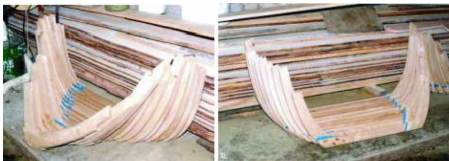
Fig. 3 - 4. Ordinate di poppa e prua di gondola già assemblate prima dell'inserimento fra le ordinate di riferimento.
