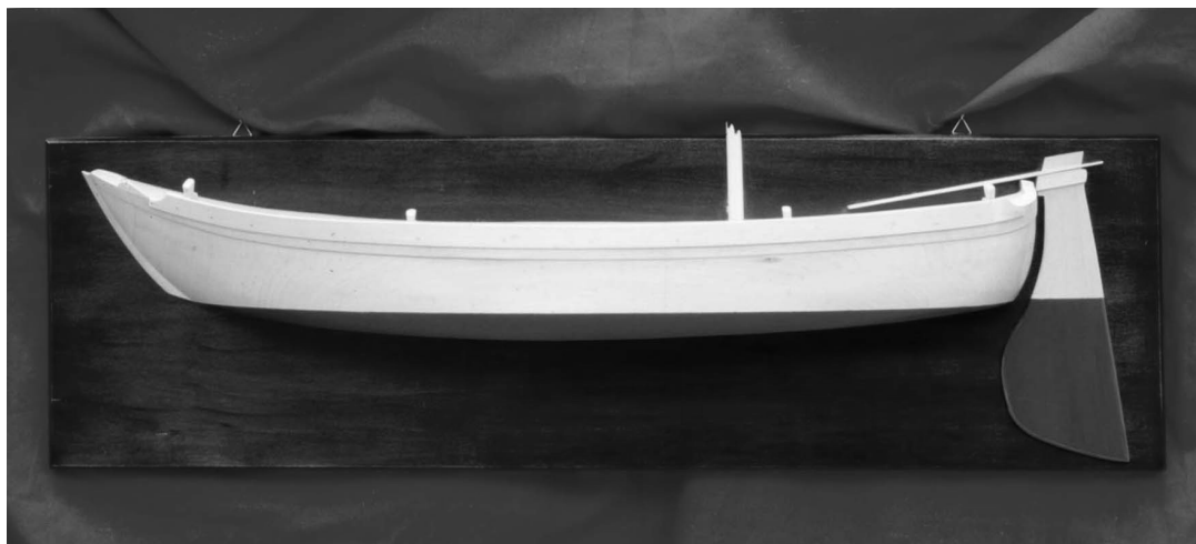
Fig. 9 Modello di topo chiojgiotto eseguito dall'autore. Si tratta di un modello costruito successivamente alla barca, per controllare l'avviamento dello scafo dopo il suo rilievo.
