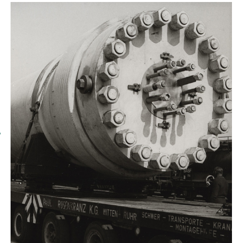
02 Transport eines Ammoniak-Hochdruckreaktors (Ofen) im Jahr 1969. Die Größe der Rohre war seit der Vergrößerung der Haber'schen Erfindung 60 Jahre zuvor gleich geblieben. Quelle: BASF SE, Unternehmensgeschichte, Ludwigshafen.
