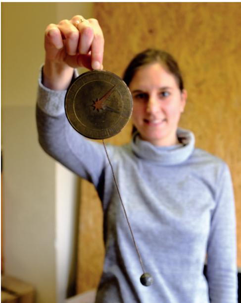
Abb. 1: Nachbau eines Pulsilogiums von Sanctorius, gefunden an der Universität Padua. Dieses Instrument dient der Messung der Pulsfrequenz. Die abgebildete Replikation war Teil einer Ausstellung, die 1961 an der Universität von Padua von Loris Premuda organisiert wurde. © Philip Scupin; Lizenz: CC-BY-NC-SA 4.0 International.
